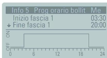
La rappresentazione grafica degli orari di riscaldamento per l'acqua calda serve a facilitare la visualizzazione delle fasce impostate (per ogni giornata è possibile programmare 6 punti di commutazione a coppie). L'indicazione ON corrisponde agli orari in cui la regolazione si basa sul valore teorico **Normale**, l'indicazione OFF quelli in cui la regolazione si basa sul valore teorico **Ridotto** risp. **Antigelo**.
