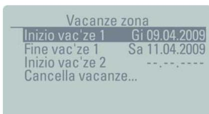
2. Ruotando la manopola per lo scrolling marcare **Inizio vac'ze** della fascia da impostare e selezionarla premendo il tasto **enter**.
